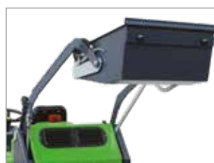
HYDRAULISCHE ENTLERUNG DES KEHRGUTBEHÄLTERS
