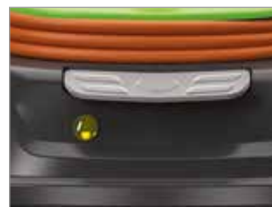
KONTROLLEUCHE BEI VOLLEM FILTER
