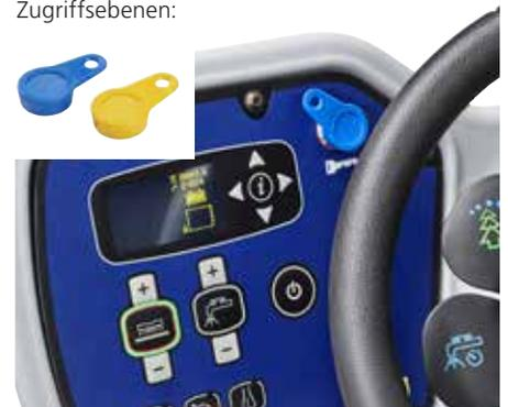
1. Anwender (blauer Schlüssel mit eigenem Code): Zugriff auf vordefinierte Reinigungsparameter
