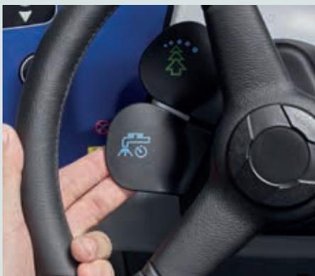
Im Lenkrad integrierte SmartFlow™-Taste zur kurzzeitigen Reduzierung der Wassermenge, z.B. bei Kurven. Dadurch wird Wasser gespart und ein Verspritzen vermieden.
